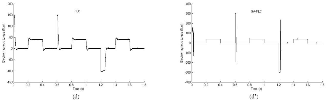
Fig. 12 electromagnetic torque response: (d) FLC (d') FLC-GA.
