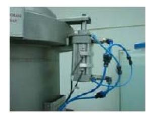
Fig. 3b pneumatic pistons
